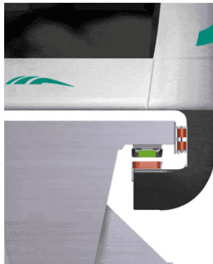
Slika br.13.8.55. Sistem namotaja koji omogućava magnetno lebdenje vozila
